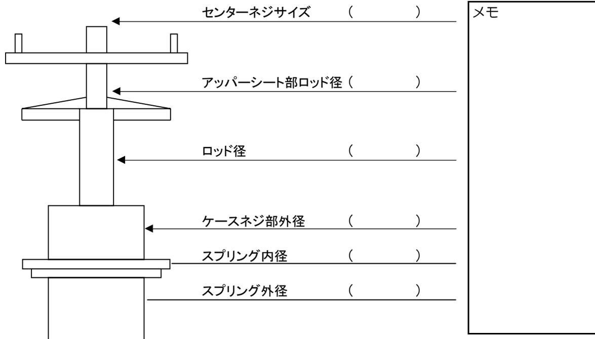
※AIR MATICシリンダーのショック取付部は約10mmの肉厚があります。また、スプリングの座面位置が20～25mm下にずれます。従って装着後そのズレが車高などに影響します。状況によりロアシート調整、あるいはその他の調整、修正が必要になることがあります。作業については、その調整を行える技術を有する方が行うようにお願い致します。
